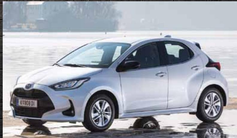
Sendo 100% híbrido, não obriga a recarregamentos a partir de fontes externas, sendo a sua potência gerada por um gerador accionado pelo motor. Acelera dos 0 aos 100 km/h em 9,7 segundos e atinge 175 km/h de velocidade máxima. Em desaceleração e travagem, a recuperação da energia cinética transforma-se em energia eléctrica, que é armazenada na bateria de elevado desempenho.
