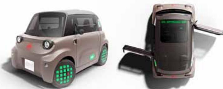
A adaptação consiste em modificar a dobradiça da porta do condutor para acentuar o ângulo de abertura e permitir que o utilizador da cadeira de rodas se posicione paralelamente à soleira do compartimento dos passageiros. Em seguida, uma prateleira amovível e retrátil, combinada com uma correia na parte superior da moldura interior da porta, permite ao cliente sentar-se no banco do condutor a partir da sua cadeira de rodas.
