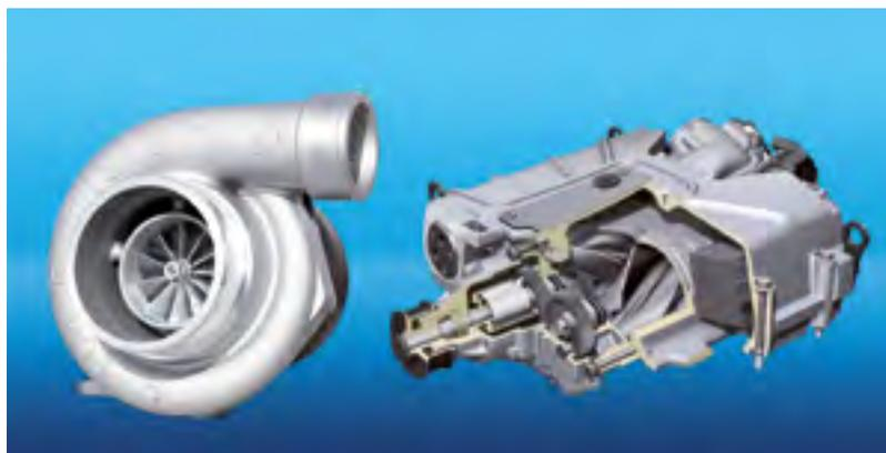
A baixa rotação simplesmente não recebe gases suficientes ou estes não se deslocam a velocidade suficiente para que a turbina gire à velocidade necessária para criar pressão. É a razão principal para fenómenos como turbo lag, ou seja, o atraso na resposta entre o abrir do acelerador e o momento em que o turbo começa a fornecer boost ou pressão.
