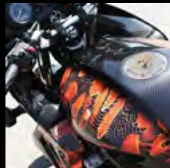
em água e outro, através de um ativador, que faz com que o padrão flutue sobre a água em forma de uma camada da tinta. A seguir basta imergir a peça inclinada na água, enxaguar os resíduos da película orgânica e aplicar uma camada de verniz que poderá ser brilhante ou mate consoante o pedido do cliente deixando a peça com um acabamento inacreditável.
