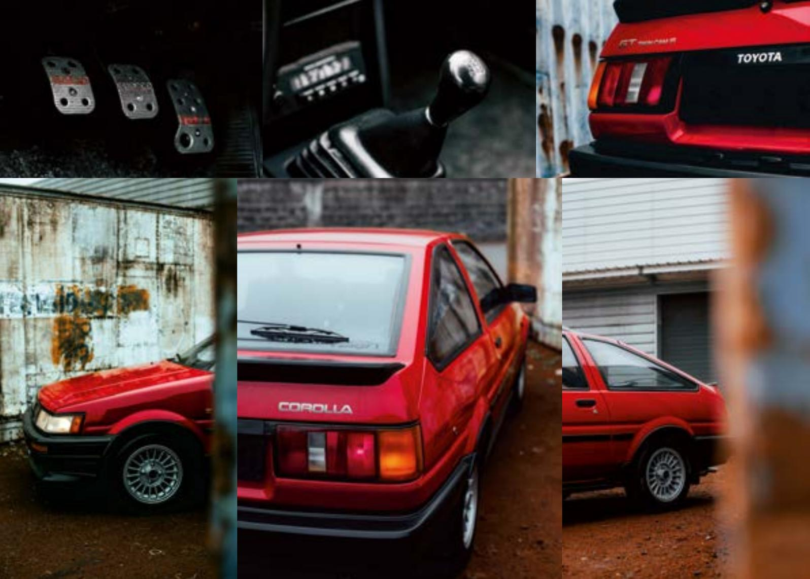
na maior parte deles mas depois veio com a opção de automático. Tinha como extra opcional o diferencial autoblocante (LSD) no fase 2 ao contrário do fase 1 que eram todos com autoblocante de origem. O AE86 utiliza travões de disco ventilados, é equipado com uma suspensão estilo MacPherson independente na frente e um eixo mola e amortecedor na traseira. Barras estabilizadoras estavam presentes em ambos os eixos.
