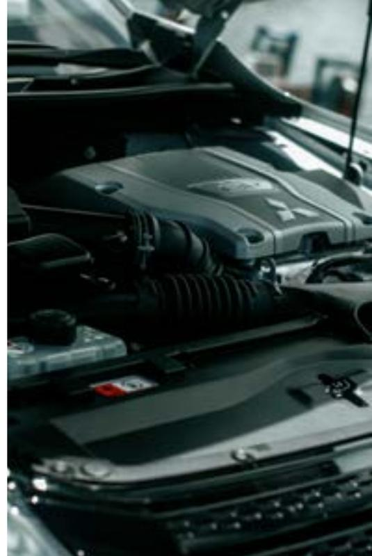
**Motor a gasolina** 2,4 litros (ciclo de Atkinson) / 98 cv / 211 Nm
